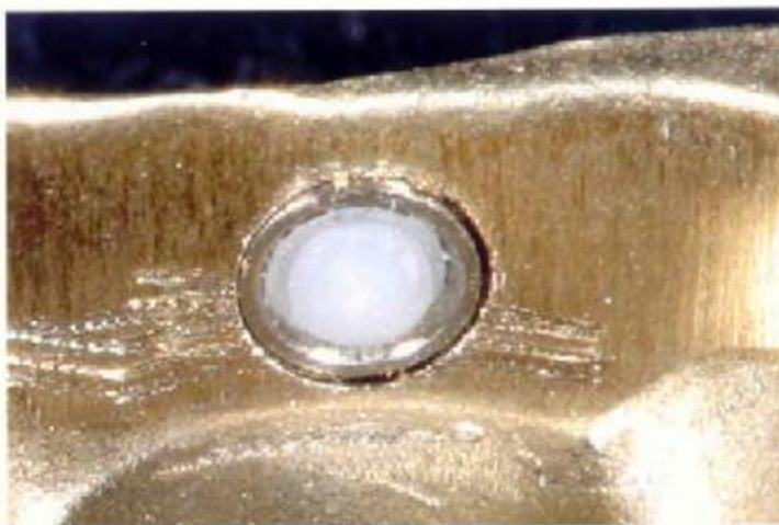
Abb. 7 Eine Passungskontrolle vor dem Verkleben in der Innenansicht ...
